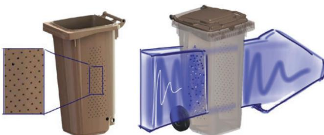
Les flancs perforés aux deux parois de la cuve favorisent la circulation de l'air à l'intérieur du conteneur. La combinaison optimale du flanc perforé et des grilles d'aération augmente encore significativement la surface de ventilation ce qui induit un séchage plus rapide ainsi qu'une réduction du poids et des odeurs.
